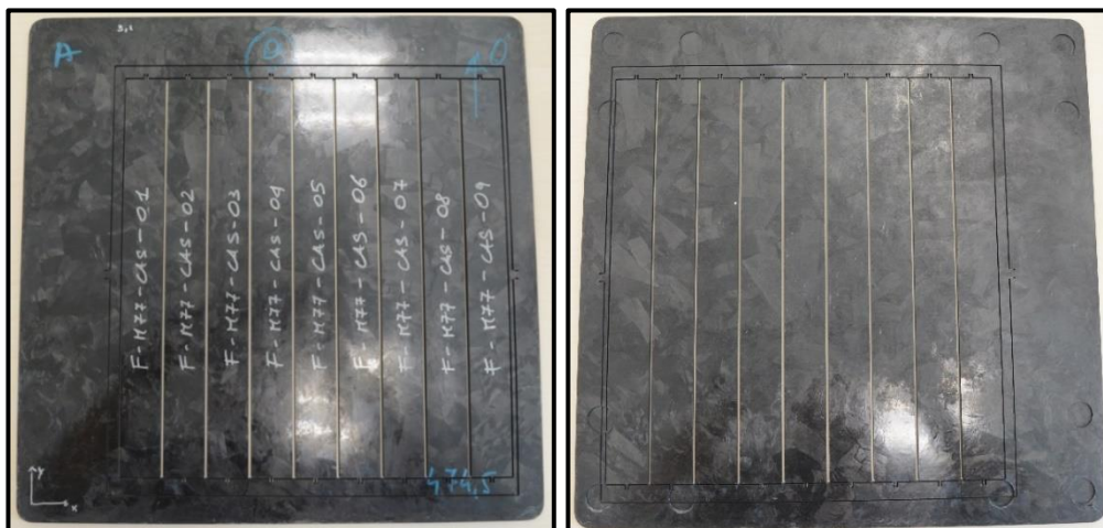
Figura 3.49: campioni F-M77-CAS 01-09 ricavati tramite taglio waterjet dalla piastra con e senza codifica.
