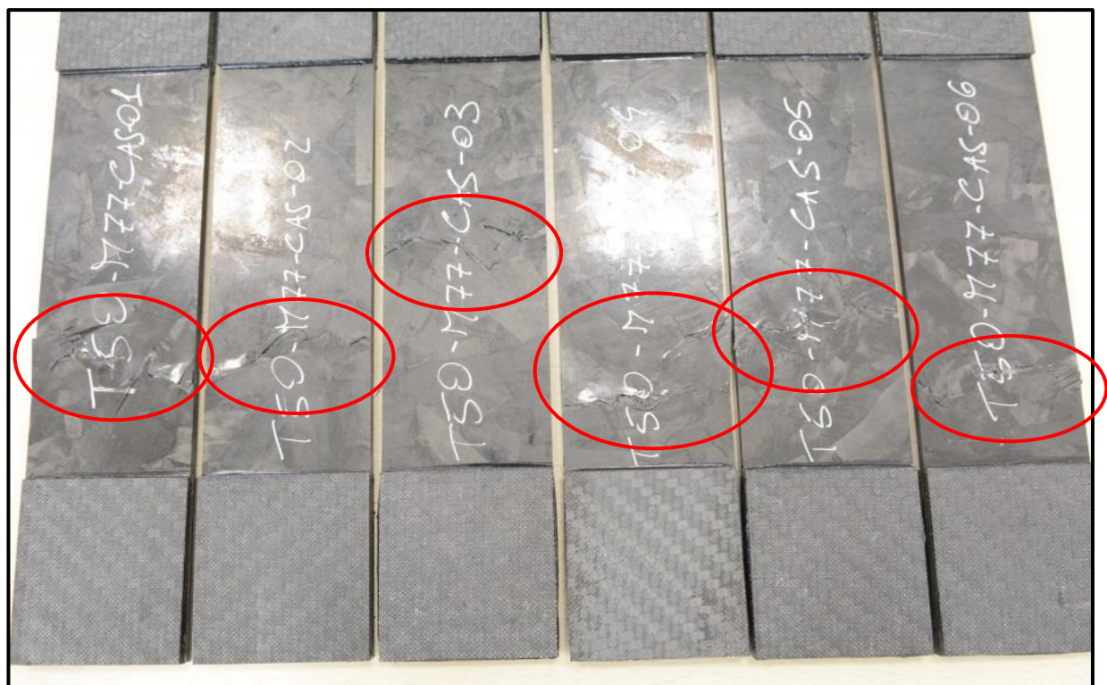
Figura 5.51: zone di frattura campioni T50-M77-CAS 01-06 (fronte).
