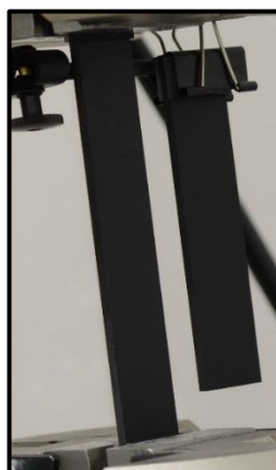
Figura 3.65: superficie del campione analizzata con termografia verniciata di nero durante la prova.
