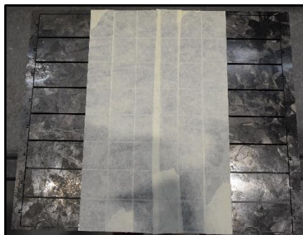
Figura 3.22: isolamento della zona tabs dalla lunghezza utile di prova.
