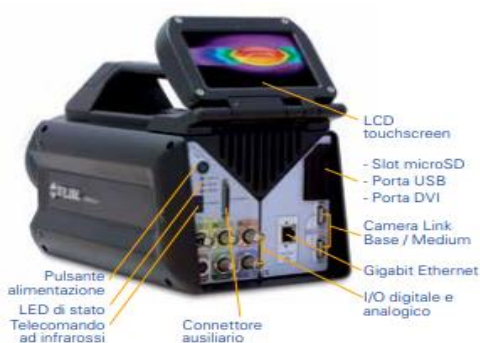
Figura 4.5 [12] : elementi principali di connettività e lettura dati della termocamera FLIR X6540sc.
