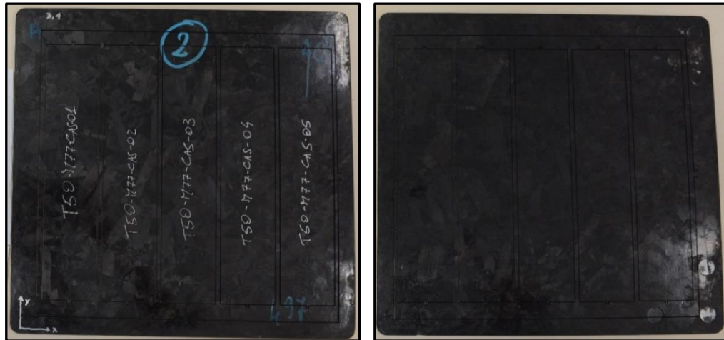
Figura 3.16: campioni T50-M77-CAS 01-05 ricavati tramite taglio waterjet dalla piastra con e senza codifica.
