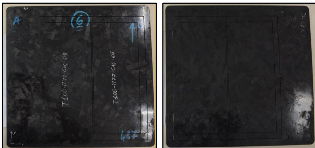
Figura 3.20: campioni T100-M77-CAS 05-06 ricavati tramite taglio waterjet dalla piastra con e senza codifica.
