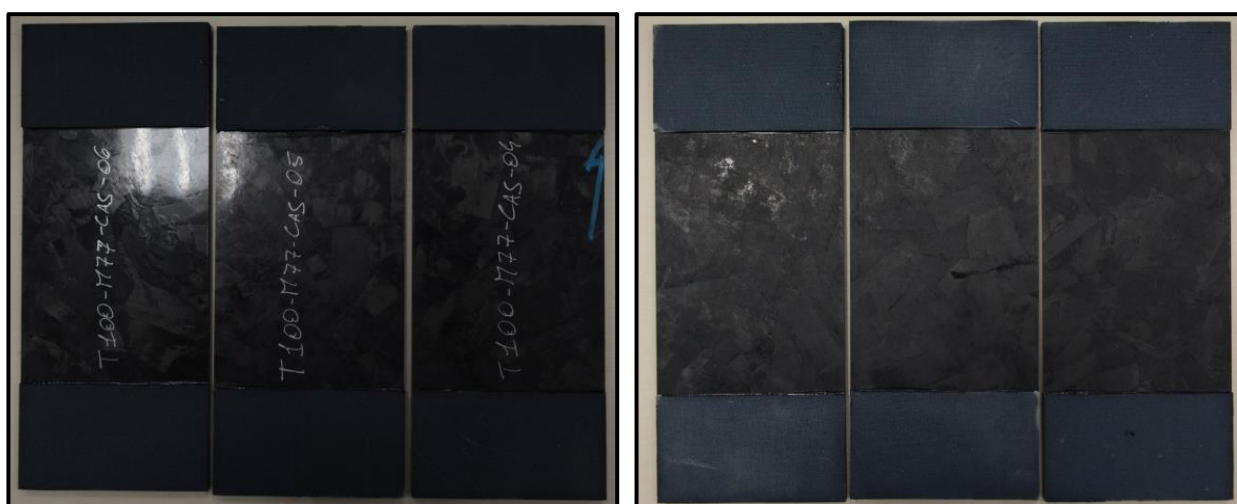
Figura 3.29: campioni T100-M77-CAS 04-06 e tabs incollate con DP490 prima dei test.
