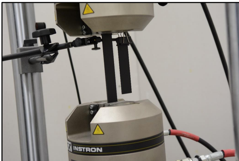
Figura 3.58: campione in prova e dispositivo di supporto per il campione di riferimento.
