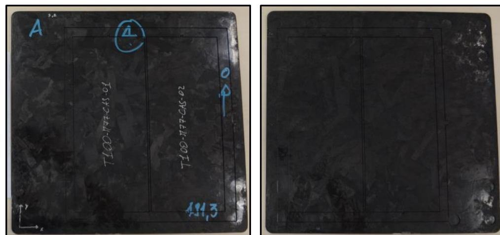
Figura 3.18: campioni T100-M77-CAS 01-02 ricavati tramite taglio waterjet dalla piastra con e senza codifica.
