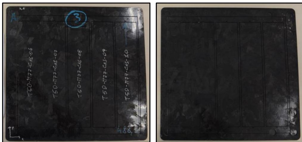
Figura 3.17: campioni T50-M77-CAS 06-10 ricavati tramite taglio waterjet dalla piastra con e senza codifica.
