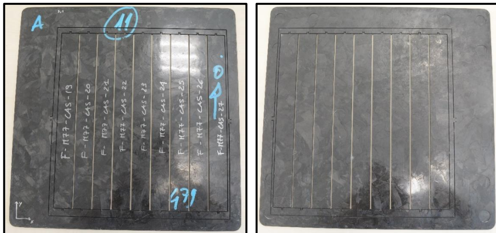
Figura 3.51: campioni F-M77-CAS 19-27 ricavati tramite taglio waterjet dalla piastra con e senza codifica.
