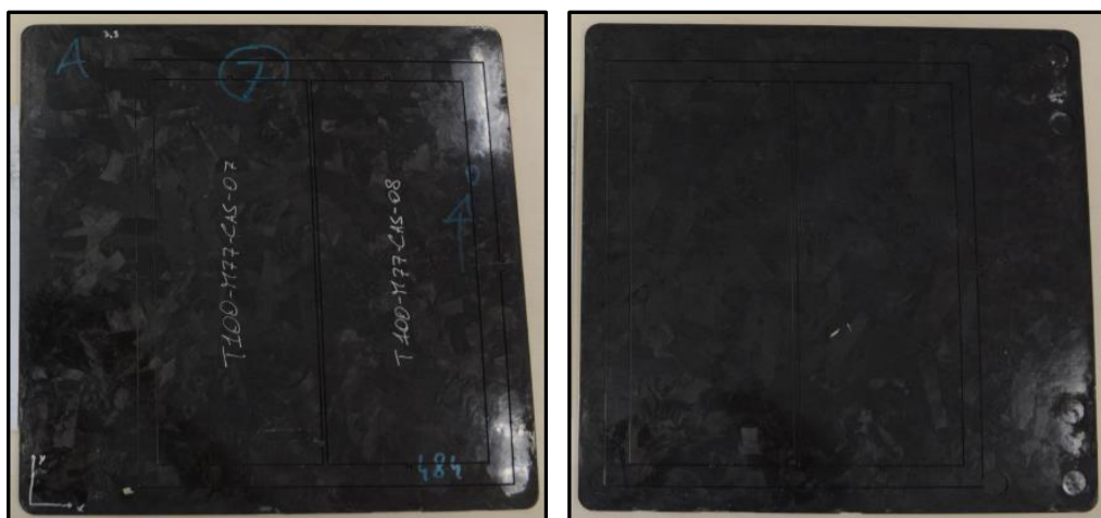
Figura 3.21: campioni T100-M77-CAS 07-08 ricavati tramite taglio waterjet dalla piastra con e senza codifica.
