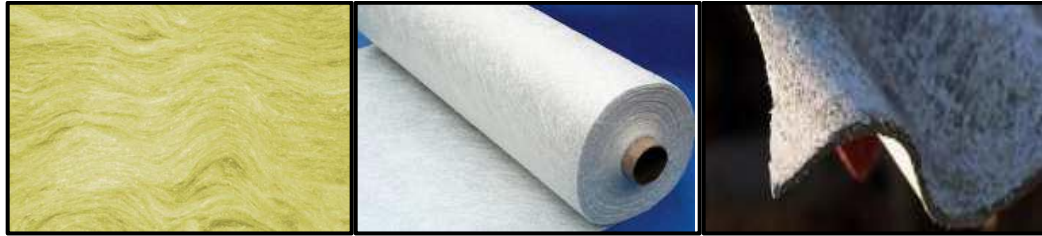
Figura 1.6 [12] : esempi di composito in fibra di vetro. Da sinistra: lana di vetro, vetroresina, fibrocemento (eternit).
