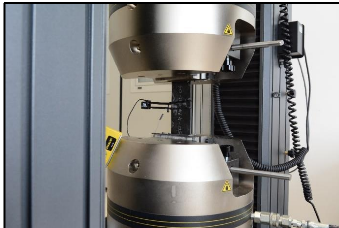
Figura 3.31: campione T50-M77-CAS 04 con estensometro monoassiale per il calcolo del modulo elastico.
