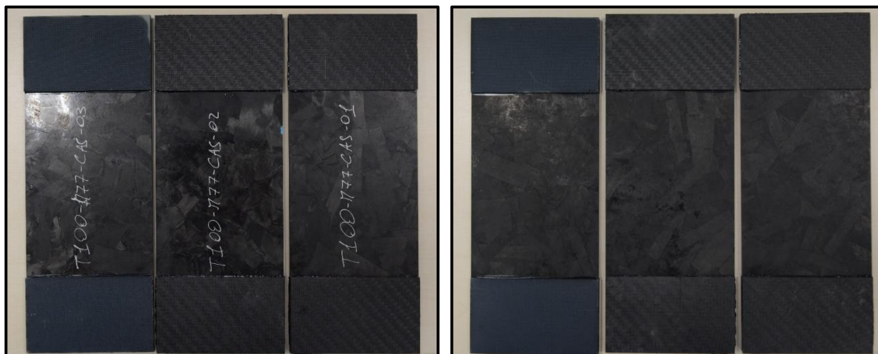
Figura 3.28: campioni T100-M77-CAS 01-03 e tabs incollate con DP490 prima dei test.
