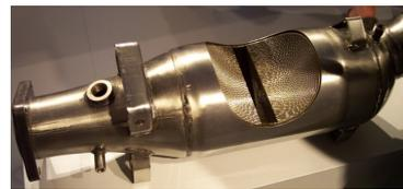
Figura 1.3: Sezione di un convertitore catalitico [6]
