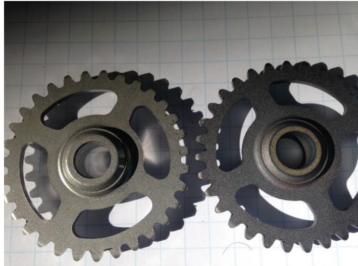
Figura 4.3.1: confronto tra 993 STD sinterizzato in endogas (sx) e 993 STD sinterizzato in azoto-metano (dx)
