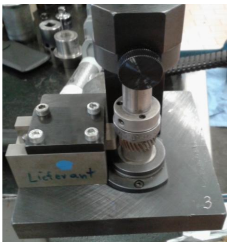
Figura 3.3.7: a sx, particolare dell'assieme di rottura impiegato per il campione 728; a dx, chiave dinamometrica impiegata per imprimere la coppia ai denti
