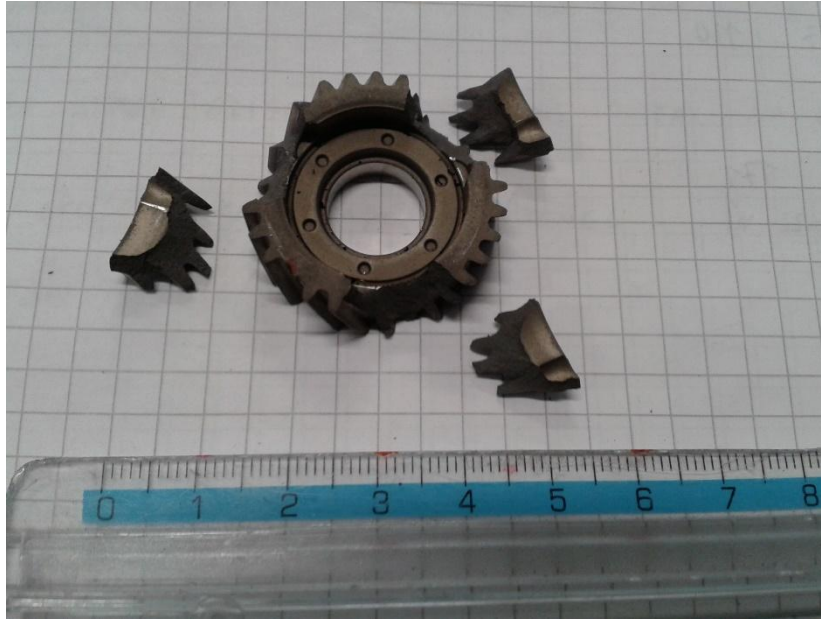
Figura 4.6.12: cedimento integrale del campione avvenuto dopo la rottura di due soli denti
