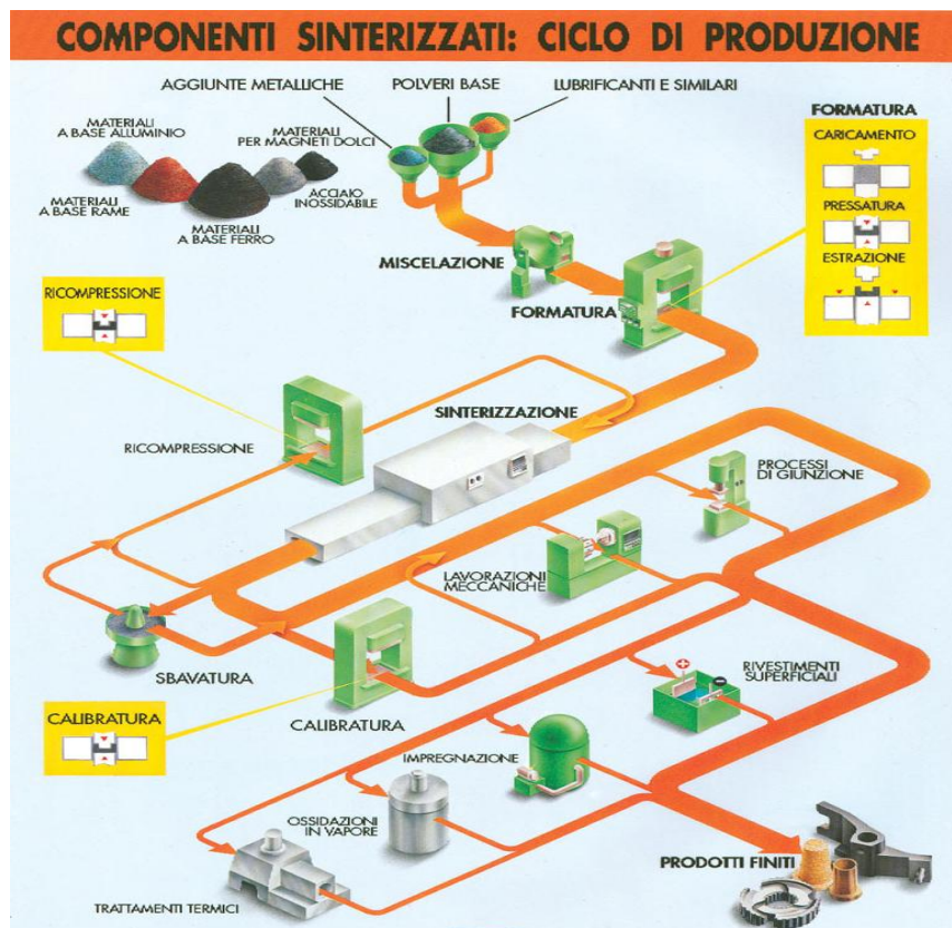
Figura 2.1: schema del ciclo di produzione di un componente sinterizzato
