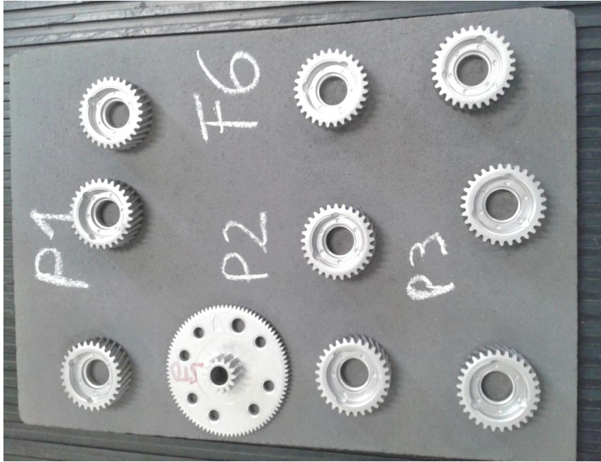
Figura 4.2.2: foto di campioni 728 delle tre composizioni al Cromo P1, P2, P3 e di un 985 STD, trattati con il ciclo F6
