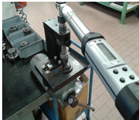
Figura 3.3.7: a sx, particolare dell'assieme di rottura impiegato per il campione 728; a dx, chiave dinamometrica impiegata per imprimere la coppia ai denti
