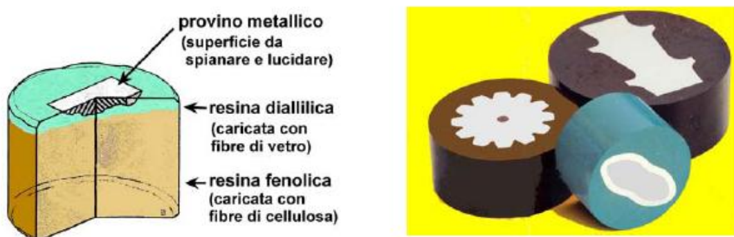
Figura 3.3.2: a sinistra, rappresentazione schematica di un provino metallografico; a destra, come si presentano realmente alcuni provini
