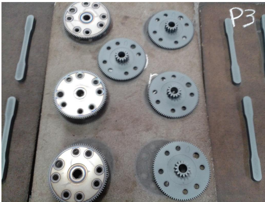
Figura 4.5.2: campioni 985 appartenenti alla seconda carica; lato di appoggio (sx) e lato superiore (dx)
