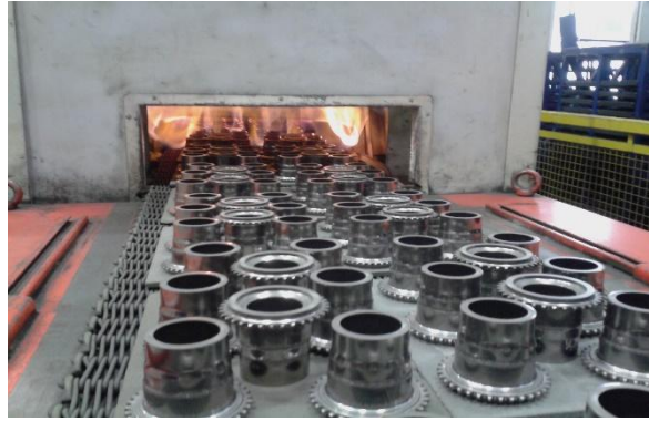
Figura 3.2.5: foto di alcuni componenti al verde disposti su mattonelle, pronti all'ingresso in forno
