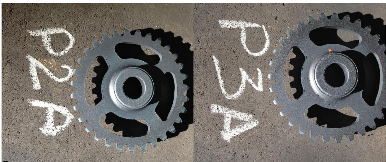
Figura 4.3.2: campioni 993 di tre composizioni diverse: P1A (in alto), P2A (in basso a sx) e P3A (in basso a dx)
