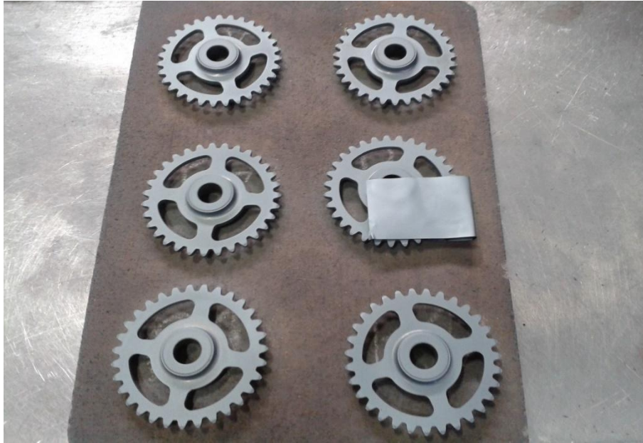
Figura 4.5.1: campioni 993 compattati con polveri al Cromo, sinterizzati nella prima carica
