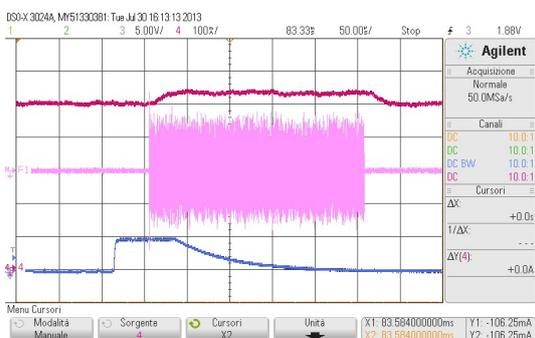
Figura 17: Segnale pacchetto Ethernet su oscilloscopio
