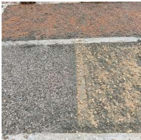
*Figura 30 prove di pavimentazione con granigliature di diverso colore, al fine di sperimentare la soluzione migliore per l'area in cui si trova il cantiere.*
