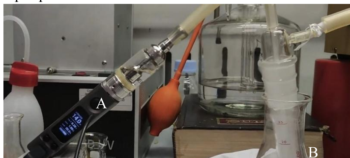
Fig2. Set-up smoking machine per la raccolta del condensato
