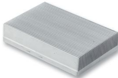
Figura 4.3: Dissipatore HS MARSTON-890SP-01500-A-100, con R_{thSA} = 0.08^{\circ}\text{C}/\text{W} e di massa 0.82\text{kg} .
