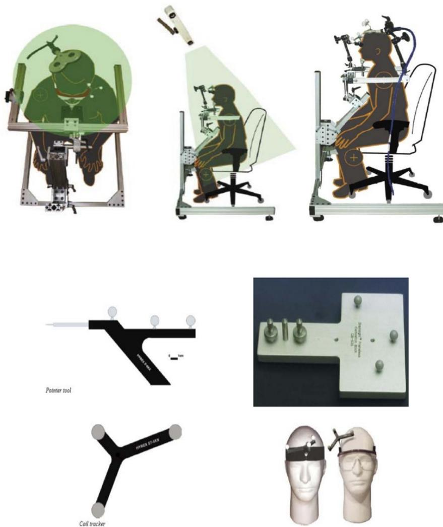
**Figura 3.** A. Sistema di telecamere ad infrarossi durante TMS. B. Sistema dei marcatori.
