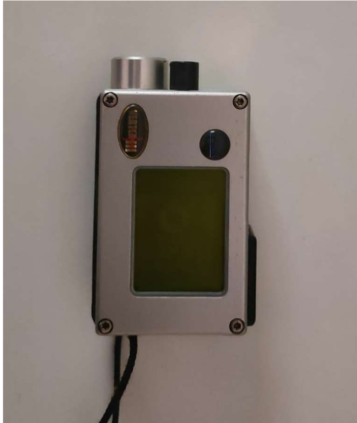
Figure 15: ipsometro Vertex, utilizzato per misurare l'altezza della pianta e dell'inserzione della chioma.
