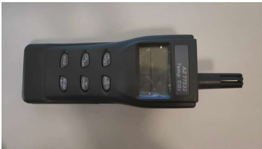
Figure 17: strumento di misura di qualità dell'aria e della temperatura.
