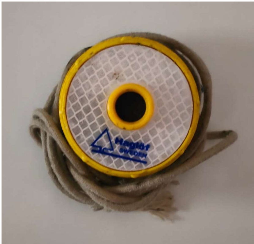
Figure 16: ricevitore, necessario per l'utilizzo per l'ipsometro Vertex.
