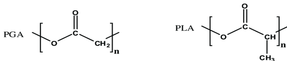
Figura 4.5 Struttura PGA e PLA.
