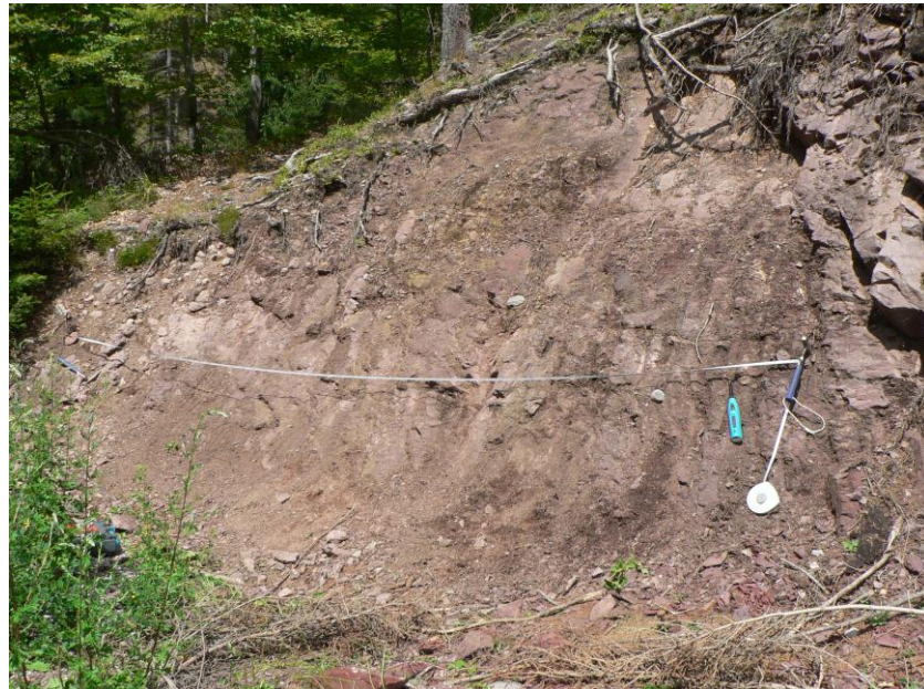
Fig. 30: Stazione geomeccanica effettuata in Arenaria di Val Gardena.
