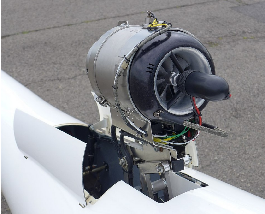
Figura 1.3.2. Piccolo motore a reazione installato su un aliante.[18]
