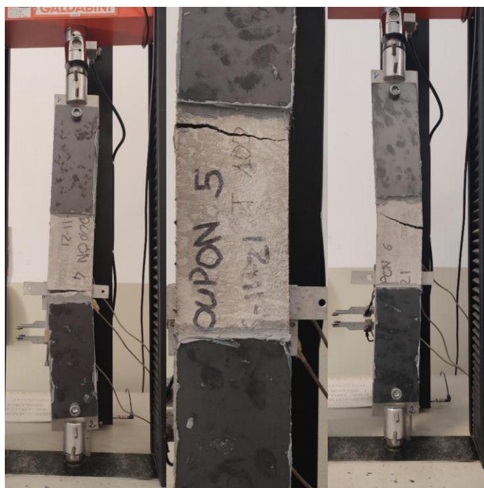
Figura 28_ Coupon rinforzati con rete in carbonio secca esposti a T=100^{\circ}
