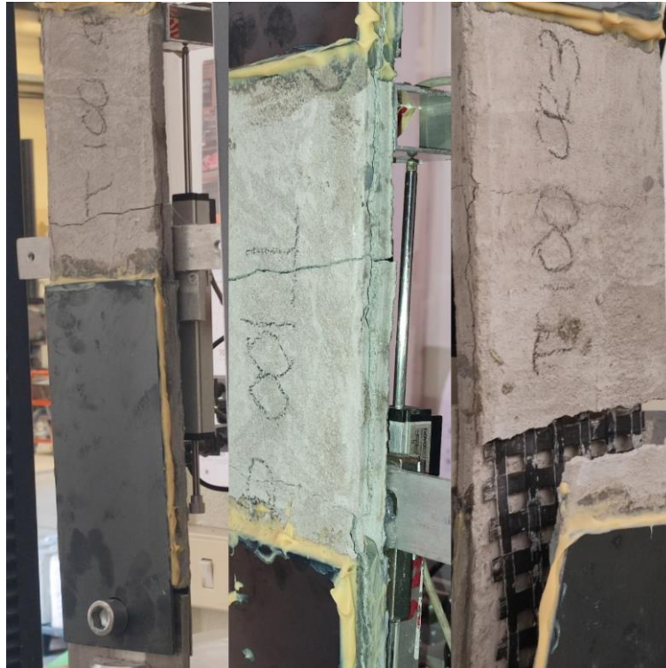
Figura 32_ Coupon rinforzati con rete in carbonio impregnata in resina esposti a T=100^{\circ}
