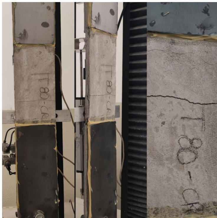
Figura 31_ Coupon rinforzati con rete in carbonio impregnata in resina esposti a T=80^{\circ}
