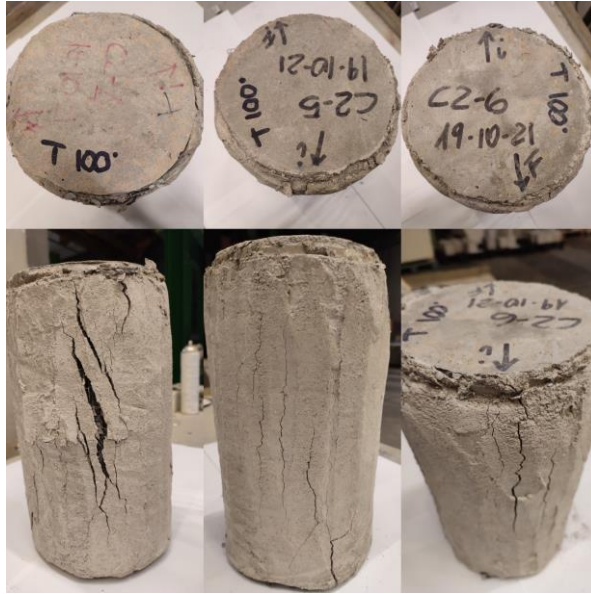
Figura 15_Campioni C2 a T=100° dopo prova di compressione semplice
