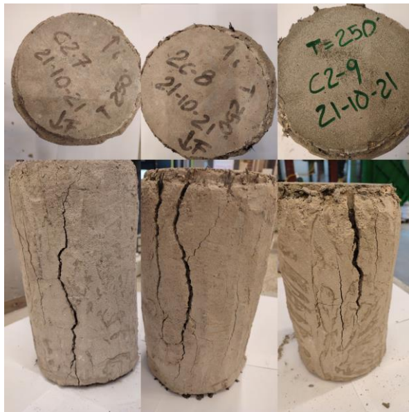
Figura 16_Campioni C2 a T=250° dopo prova di compressione semplice
