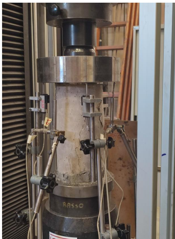
Figura 12_ Posizionamento potenziometri durante la prova
