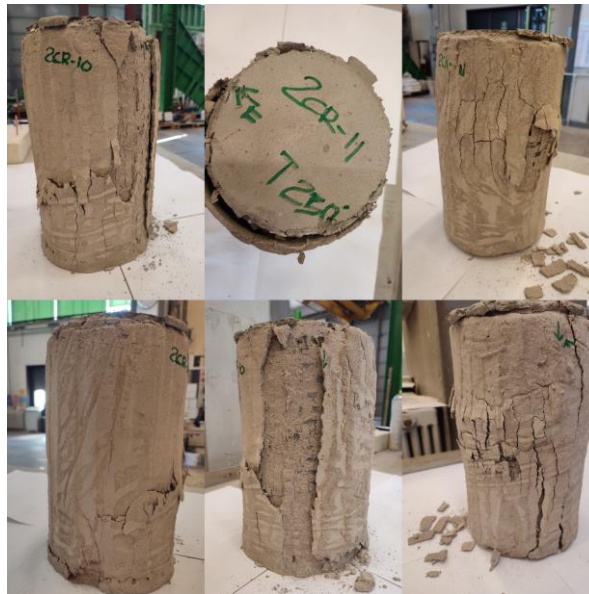
Figura 20_Campioni 2CR a T=250° dopo prova di compressione semplice
