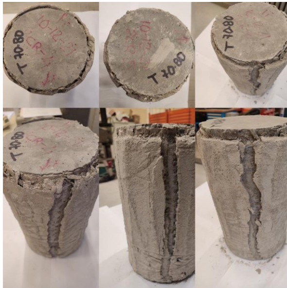
Figura 18_Campioni 2CR a T=80^{\circ} dopo prova di compressione semplice
