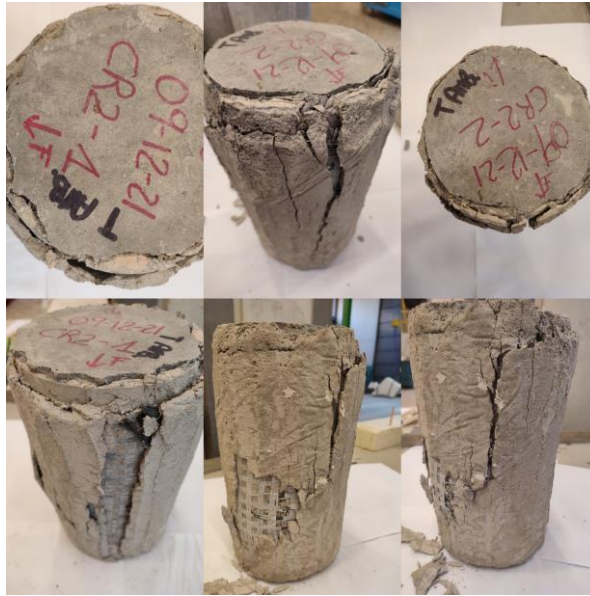
Figura 17_Campioni 2CR a T=Amb dopo prova di compressione semplice
