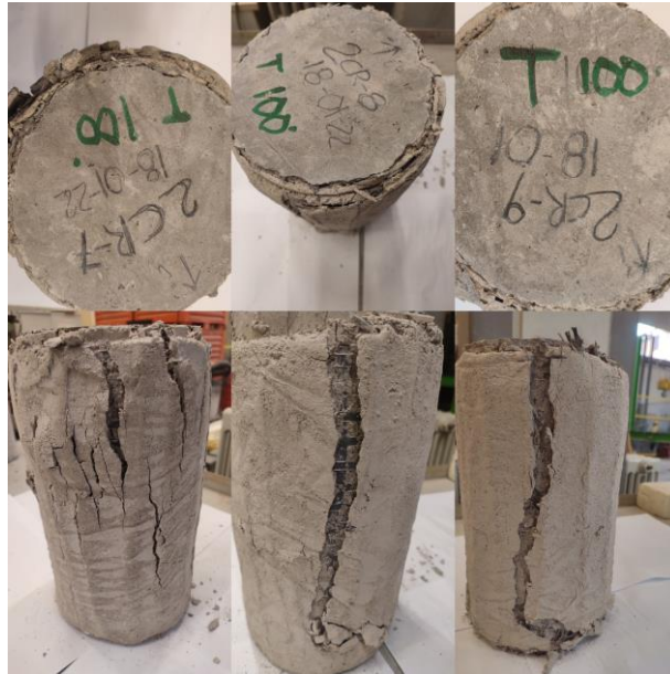
Figura 19_Campioni 2CR a T=100° dopo prova di compressione semplice
