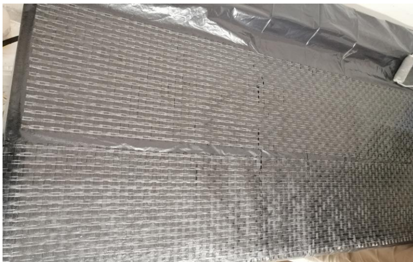
Figura 8_ Rete in carbonio impregnata attraverso adesivi epossidici prima del rinforzo dei campioni
