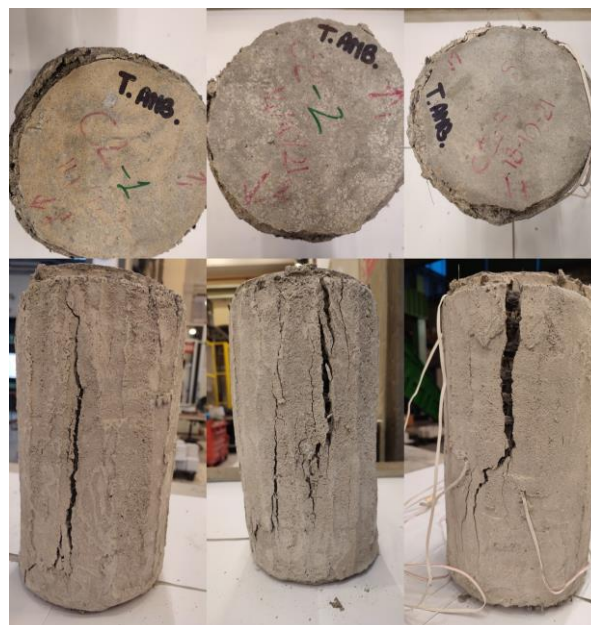
Figura 14_ Campioni C2 a T=Amb dopo prova di compressione semplice
