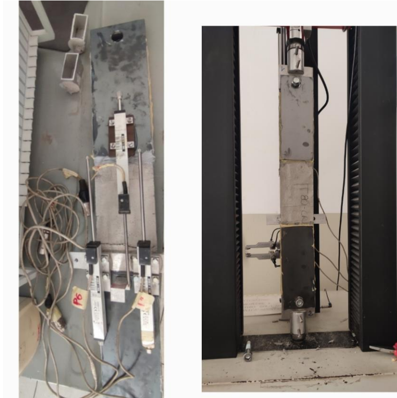
Figura 21_ Posizionamento potenziometri durante prova di trazione sui coupon
