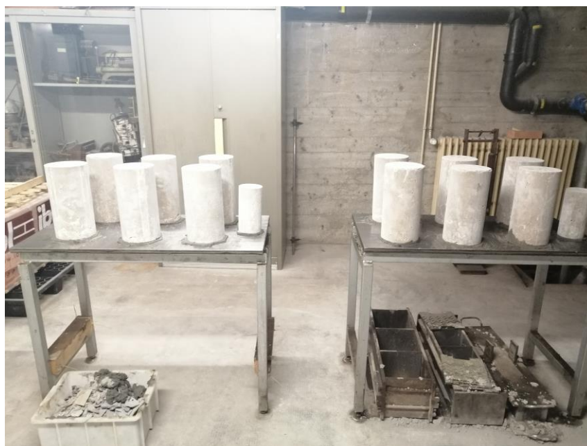
Figura 7 _ Linearizzazione della superficie dei campioni attraverso l'utilizzo di malta
