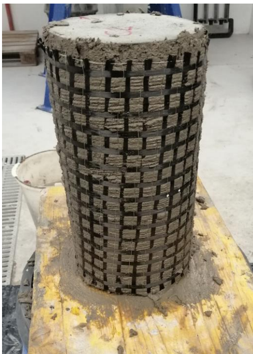
Figura 9_ Campione rinforzato (è assente lo strato finale di malta al fine di poter realizzare lo scatto riportato)
