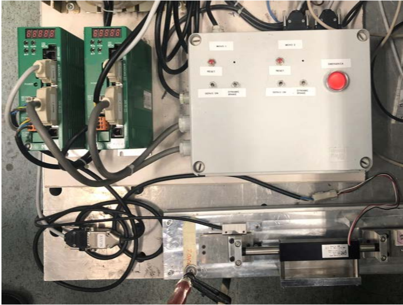
Figura 2.3: Setup sperimentale: in alto a sinistra l'azionamento MOVQ2 SVFM1-F3-DSP, in basso a destra il motore lineare GHC S120Q.
