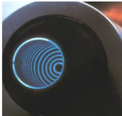
Figura 2.2: Illuminatore di forma conica.
