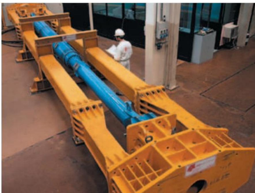
Figura 4.10: Prova su un dissipatore viscoso presso il laboratorio FIP
