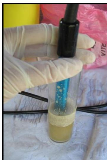
Foto n.6: misurazione del pH con elettrodo
