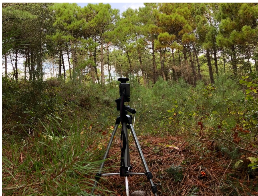
Figura 3.6. Macchina fotografica Nikon Coolpix 990 dotata di lente emisferica utilizzata per i rilievi della copertura arborea.
