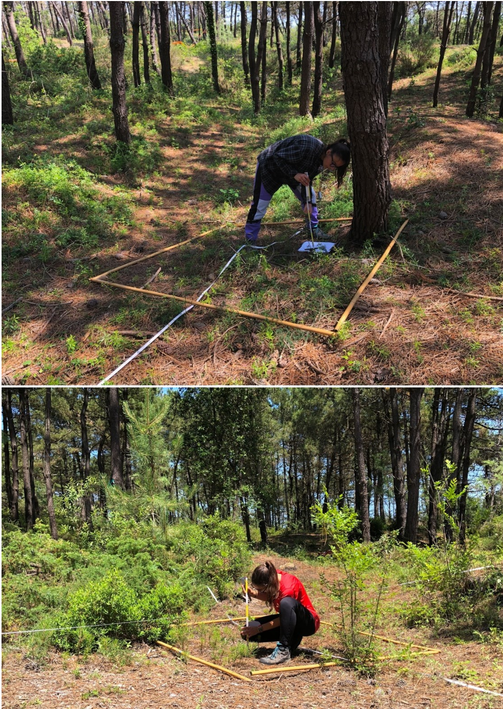
Figura 3.4. Misurazione del diametro al colletto e dell'altezza, rispettivamente con calibro e metro ripiegabile, di tutta la rinvazione arborea e arbustiva presente nei quadrati temporanei di lato 2 \times 2 m.
