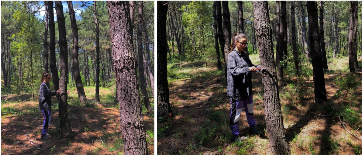
Figura 3.5. Rilevazione del diametro a petto d'uomo, con cavalletto dendrometrico, del popolamento forestale adulto sia all'interno dell'area di saggio, sia nelle piante di margine della buca a raso.
