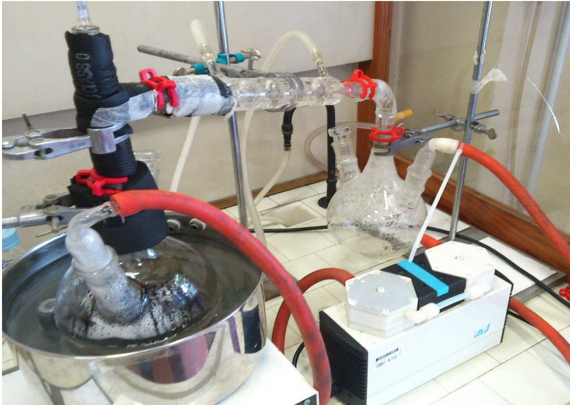
Figura 2.2 Foto dell'evaporatore del percolato
