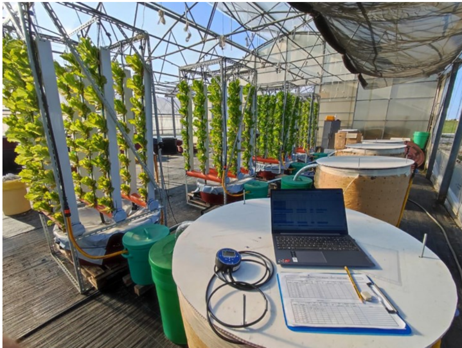
Figura 16 – Raffigurazione dei rilievi pomeridiani effettuati tramite ossimetro portatile “Handy Polaris 2 (OxyGuard) di ossigeno disciolto, % saturazione e temperatura dell’acqua.
