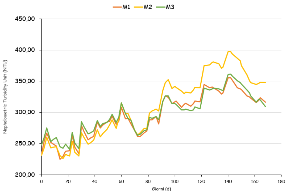
Figura 25 – Andamento della torbidità (NTU) nei sistemi acquaponici in funzione della dieta somministrata.
