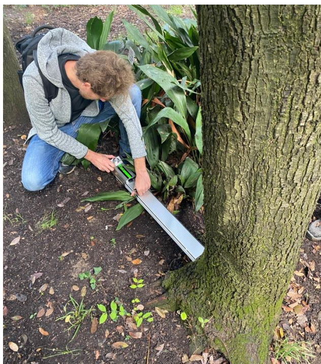
Figura 4 - Controllo con Resistograph®
