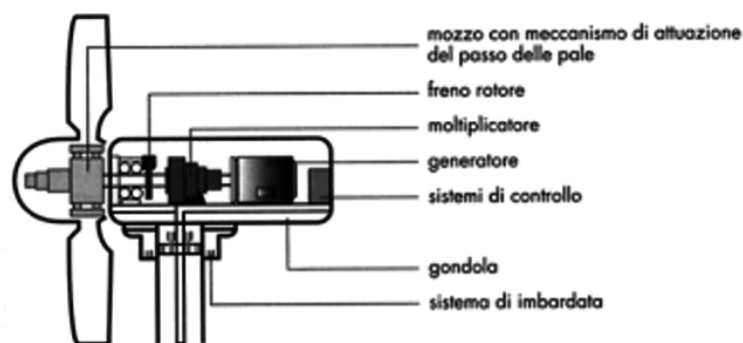
FIG.2 Componenti principali di un generatore eolico
