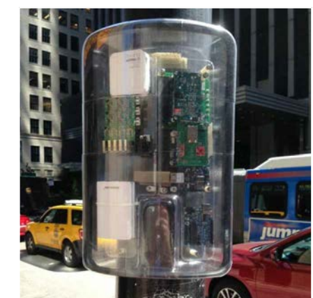
Esempio di "nodo" messo a punto per il progetto Array of Things
