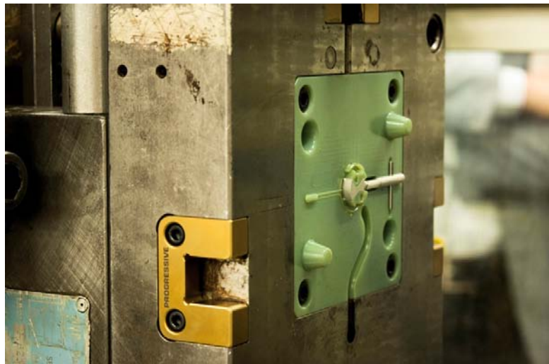
Figura 2.5: Stampo in materiale polimerico prodotto da Stratasys
