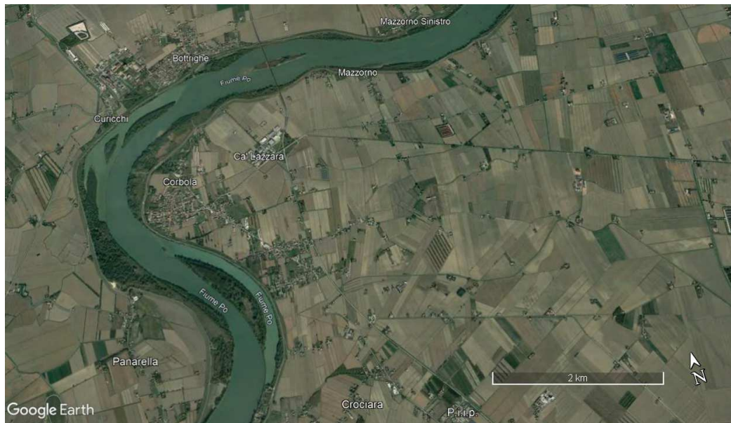
Figura 3.1: Barre longitudinali vegetate al centro dell'alveo e lungo le sponde presso Bottrighe di Adria (RO) (Google Earth, 2021).
