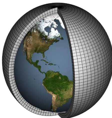
Figura 3: Rappresentazione della griglia tridimensionale del globo terrestre su cui si basa la modellazione climatica.
