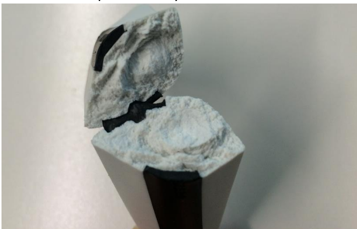
Figura 105 – superficie di frattura del componente
