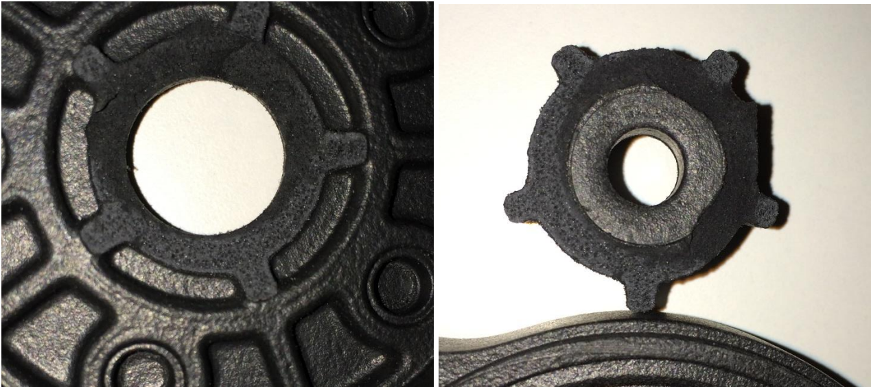
Figura 99 - provino flangia Tilt dopo rottura – superficie di rottura
