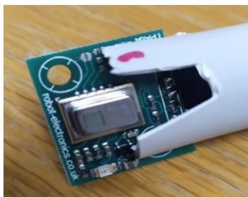
Fig. 35 – il sensore termico AMG8833 con il relativo supporto
