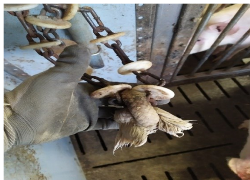
Fig. 27c – particolare della corda mangiata e ormai da cambiare dopo circa tre settimane di prova
