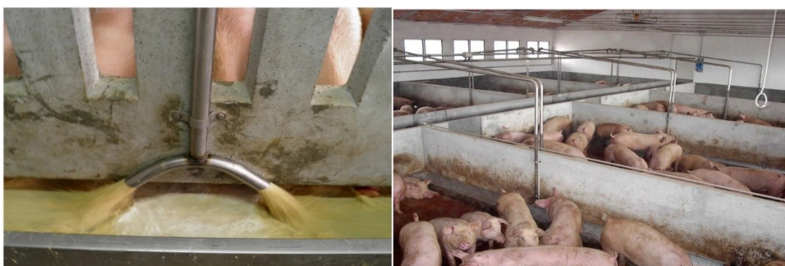
Fig. 17a – somministrazione dell'alimento liquido, 17b – vista di un impianto di alimentazione (Cima)
