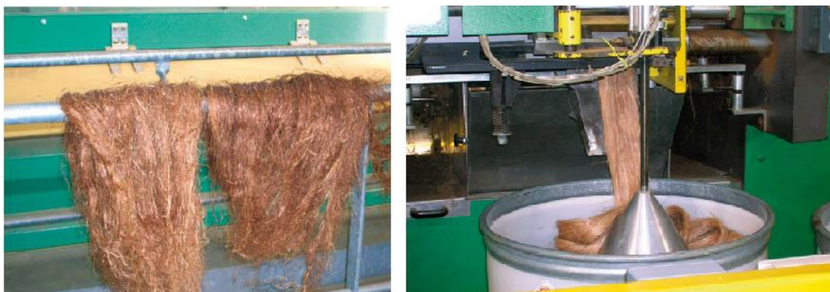
Figura 3. Uno stigliato lungo e un particolare dell’impianto di pettinatura. (Fonte: Manuale di coltivazione e prima lavorazione della canapa)
