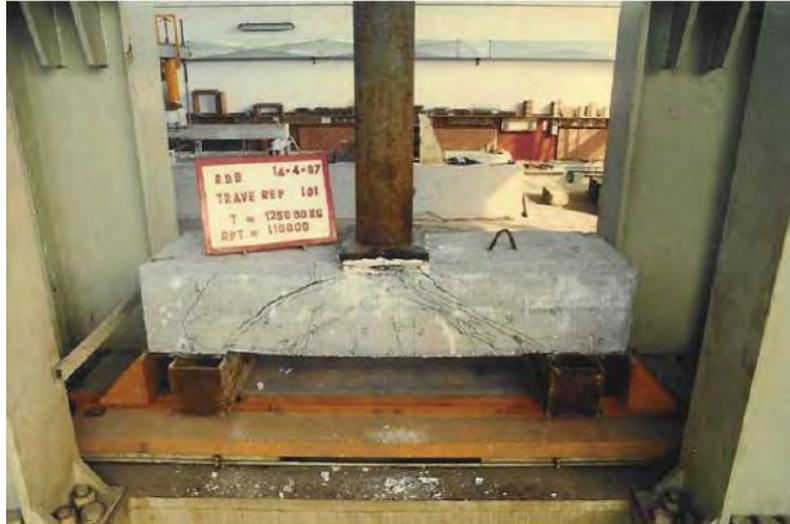
Trave 101: rottura a 1250kN per crushing del calcestruzzo (Minelli e Riva, 2009).
