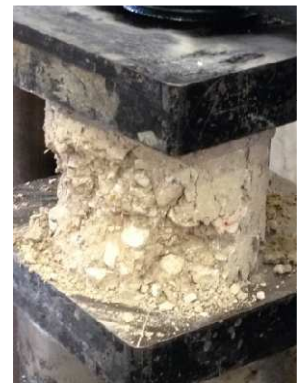
Figura 85: Rottura provino Auronzo
