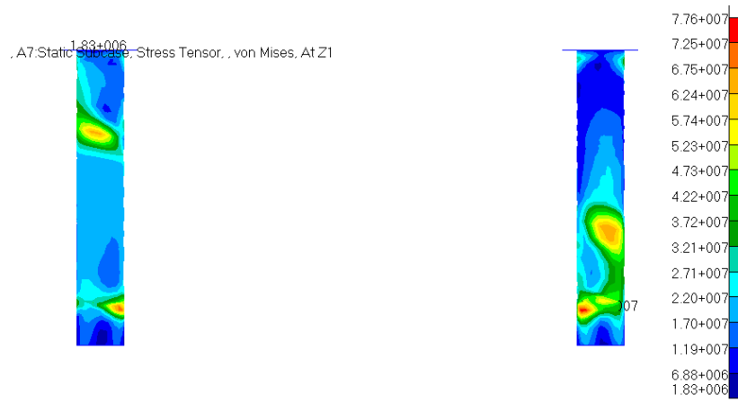
Fig. 3.83 – Stress tensor delle spine. Load case: Atterraggio_Cabrato.
