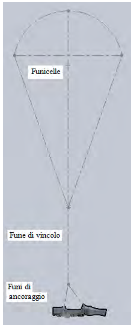
Fig. 1.39 - Schizzo delle dimensioni e funi del paracadute.
