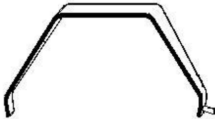
Fig. 1.26 - Esempio di carrello a balestra mono-foglia [13]
