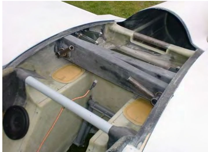
Fig. 1.11 - Scatola dei longheroni dell'aliante HP-24 della HpAircraft [14].
