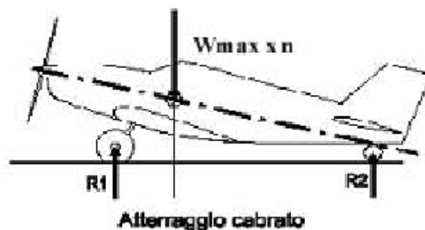
Fig. 2.3 – Forze R1 e R2 da applicare nel caso di atterraggio cabrato [3]
