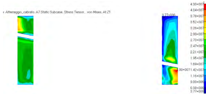
Fig. 3.84 – Stress tensor dei cilindri. Load case: Atterraggio_Cabrato.
