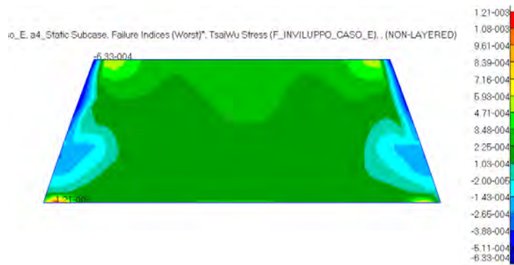
Fig. 3.44 - Indici di failure massimi del piano di appoggio del paracadute. Load Case: Inviluppo_Caso_E
