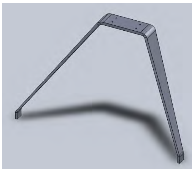
Fig. 1.30 - Carrello d'atterraggio. Vista isometrica.
