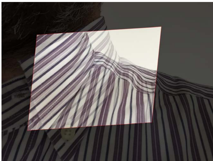
Figura 3.8: Risultato dell'allineamento delle immagini della camicia ruotate e salvate con formato PNG, utilizzando l'algoritmo gerarchico con modello affine e dimensione del template del 50%.
