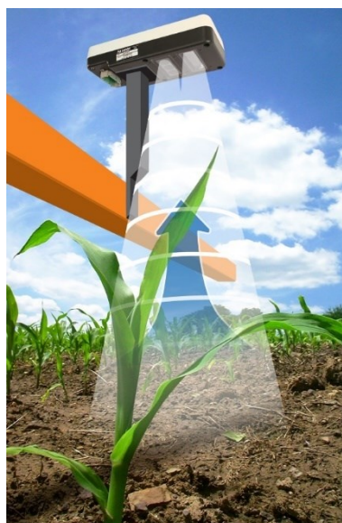
Figura 3. Modalità di funzionamento di Crop circle
