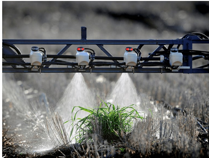
Figura 4. Weedseeker in funzione
