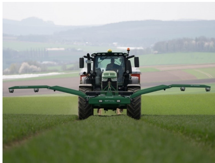
Figura 2. GreenSeeker posizionato nella parte anteriore del trattore al fine di variare la dose di fertilizzante
