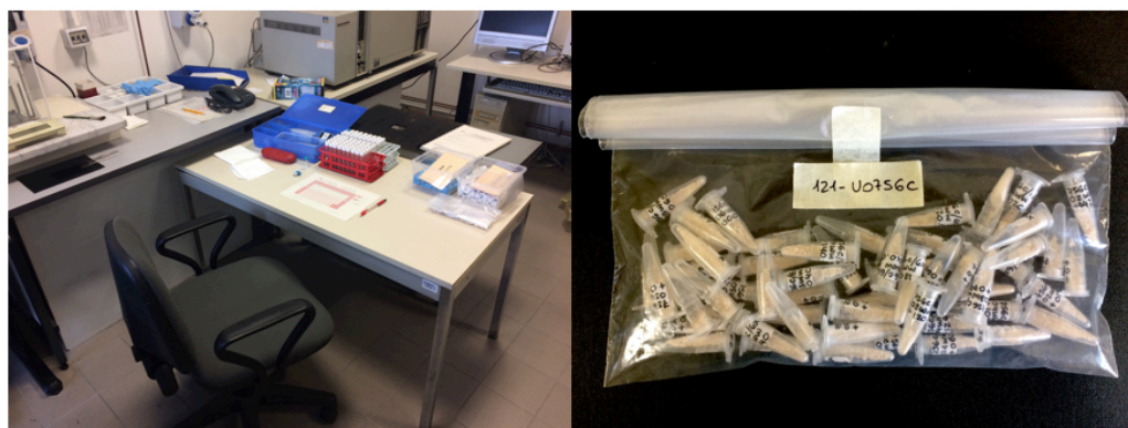
Figura 3.8. A sinistra: postazione per la pesatura dei campioni per l'analisi spettrometrica. A destra: capsule in polietilene siglate contenenti le polveri dei vari campioni.
