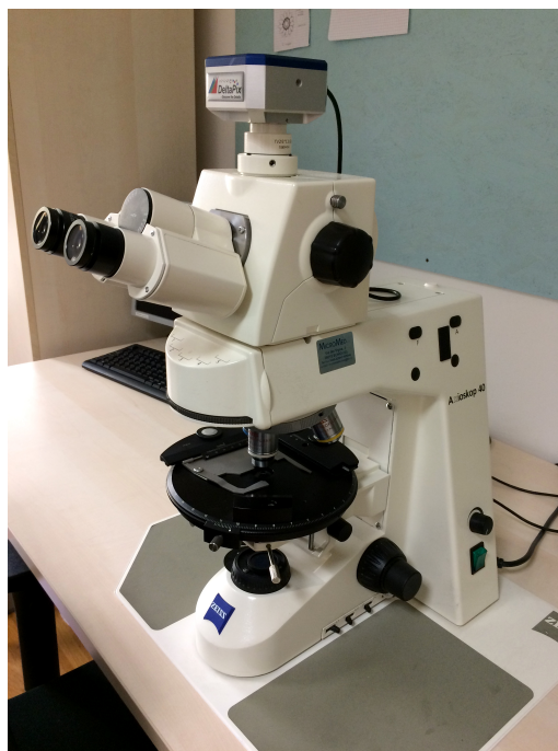
Figura 3.6. Microscopio ottico polarizzatore utilizzato per l'analisi dei campioni.
