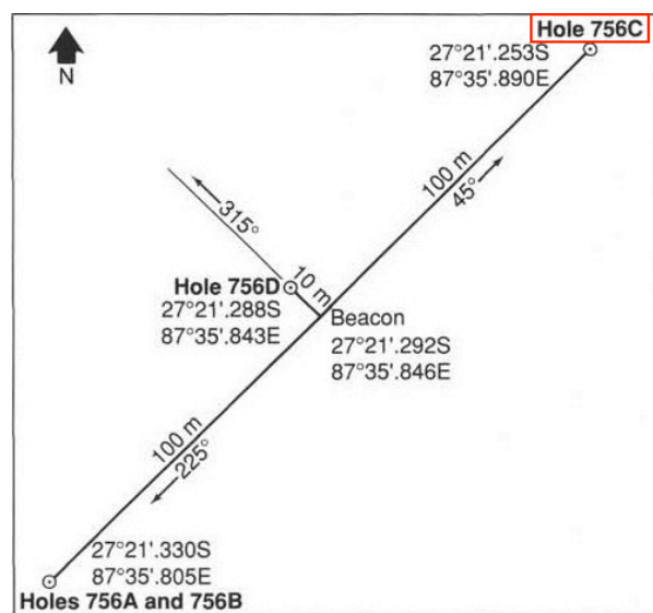
Figura 3.1. Posizione della nave durante la perforazione dei quattro hole (A, B, C e D) del Site 756. (Peirce et al., 1989)
