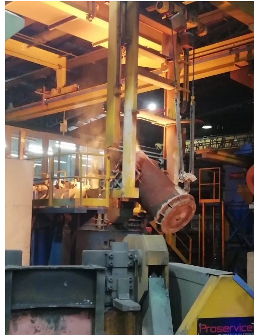
Figura 34: Spillaggio ghisa in CAP 8
