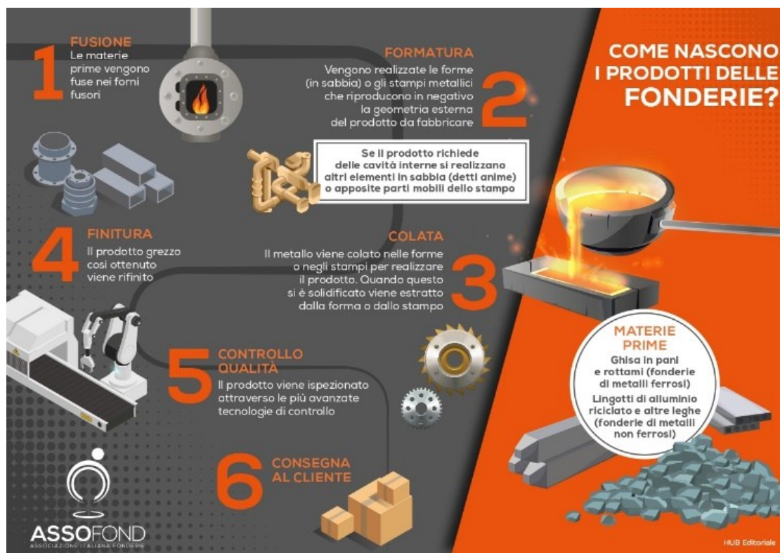
Figura 14: Processo produttivo delle fonderie (schema ASSOFOND)
