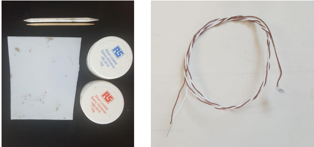
Figura 9.6 A destra utensili e resina bicomponente usata nelle operazioni di incollaggio delle termocoppie; a sinistra i cavi di rame-costantana della termocoppia.
