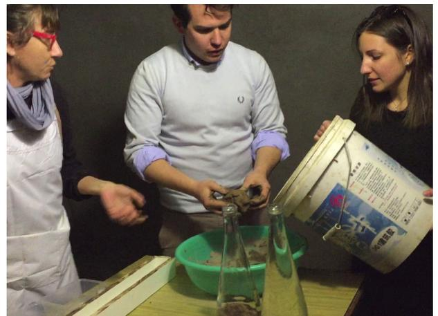
**Figura 6.7.** Aggiunta di terra setacciata per compensare l'eccessiva acqua usata
