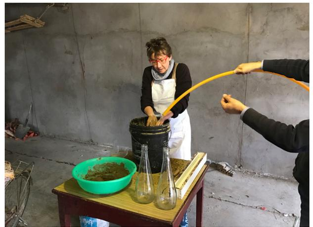
**Figura 6.5.** Fase di inumidimento della terra
