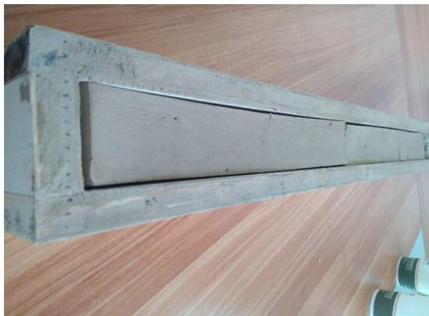
**Figura 6.13.** Risultato del test d' Alcock o di ritiro lineare
