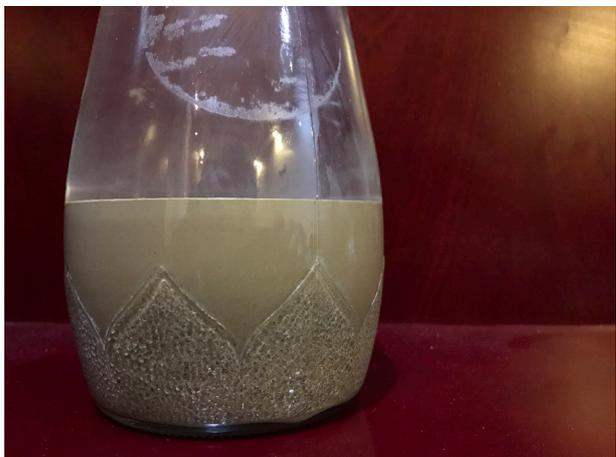
**Figura 6.12.** Stratigrafia della sedimentazione dopo 24 ore
