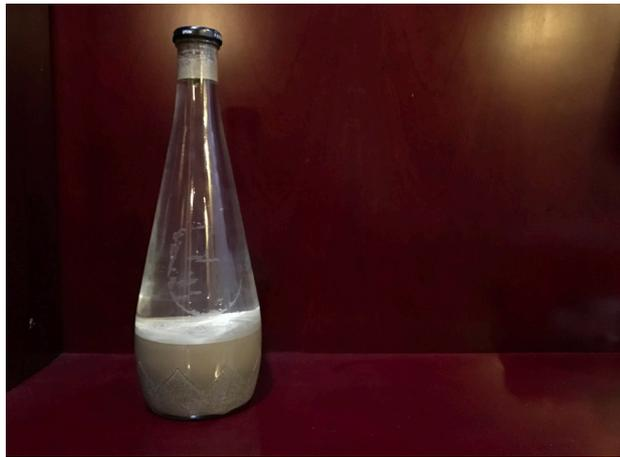
**Figura 6.11.** Sedimentazione ottenuta dopo 45 minuti di riposo della terra
