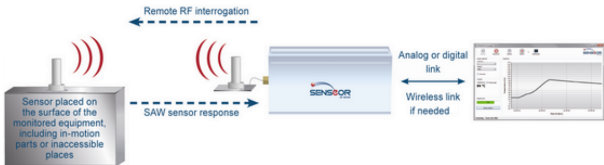
Figura 2.4: Schema semplificato di una comunicazione SAW.
