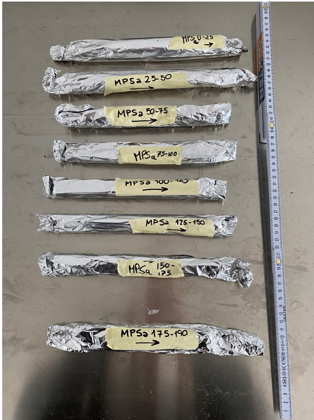
Figura 4. Carota suddivisa in segmenti di 25 cm, avvolti in alluminio per la loro conservazione. In ogni segmento è indicata la direzione di approfondimento e la profondità del campione.
