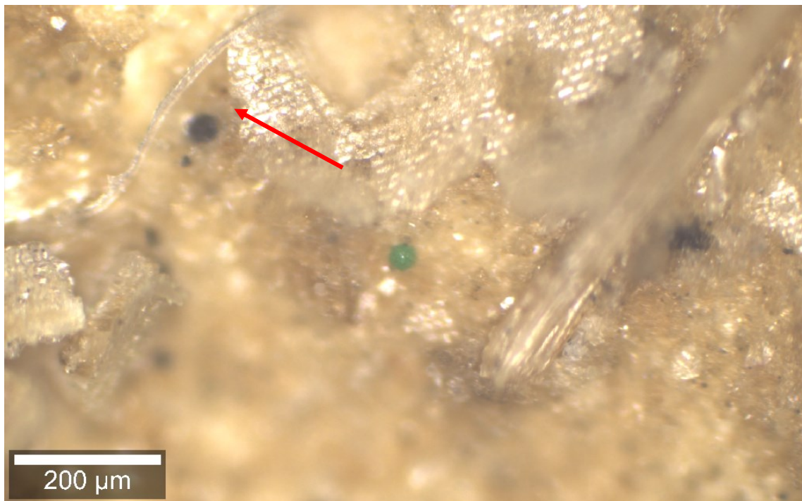
Figura 15. Mappa di filamento plastico riconosciuto come polipropilene (mappa intervallo 0-4 cm)
