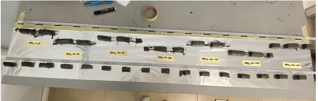
Figura 5. Suddivisione della carota e prelievo di campioni di 4 cm ad intervalli di 11 cm
