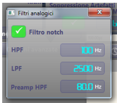
Figura 2.5: Filtri analogici utilizzati: filtro Notch attivo, HPF=High Pass Filter, LPF=Low Pass Filter, Preamp HPF=frequenza di prefiltraggio
