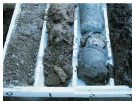
Immagini relativi ai carotaggi eseguiti sulle fondazioni ed ai provini ricavati
