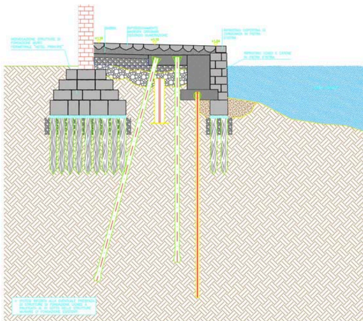
Intervento sul Canal Grande con micropali. Sezione_Scala 1:100
