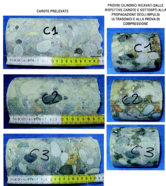
Immagini relativi ai carotaggi delle fondazioni ed ai provini ricavati
