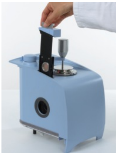
Fig. 2.4 : Universal ATR Sampling Accessory della Perkin Elmer.
