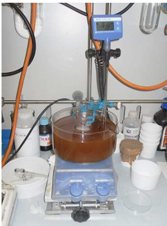
Fig 2.1 : piastra magnetica termo-riscaldata e beaker immerso nel bagno di olio di silicone.
