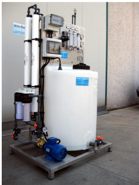
Fig.5: Impianto osmosi inversa
