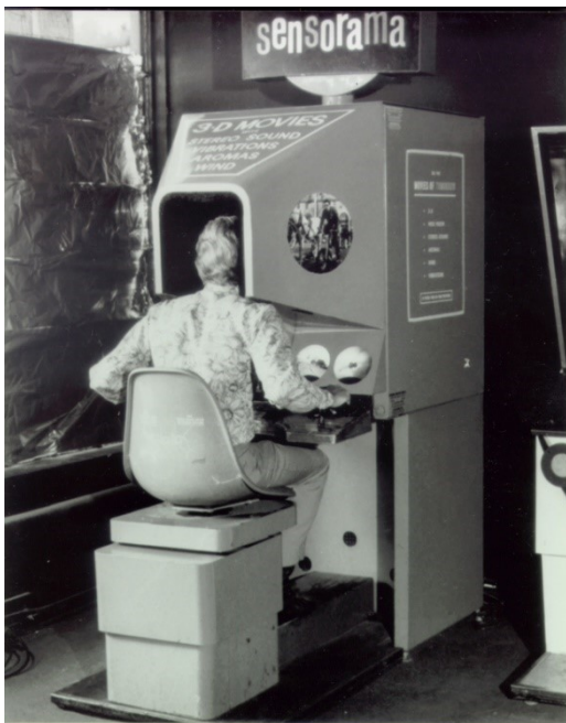
Figura 6: primo visore per la realtà virtuale, il Sensorama di Heilig [12]
