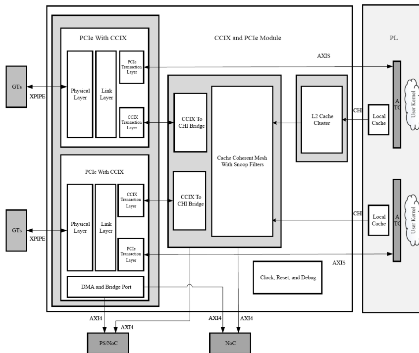
Figura 8.2: Schema del CPM4 [28, Pag.8]
