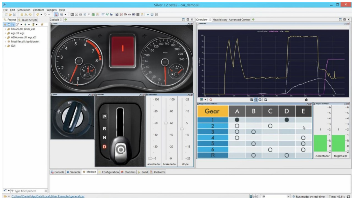
Figura 10. Silver, un software per simulare gli ECU
