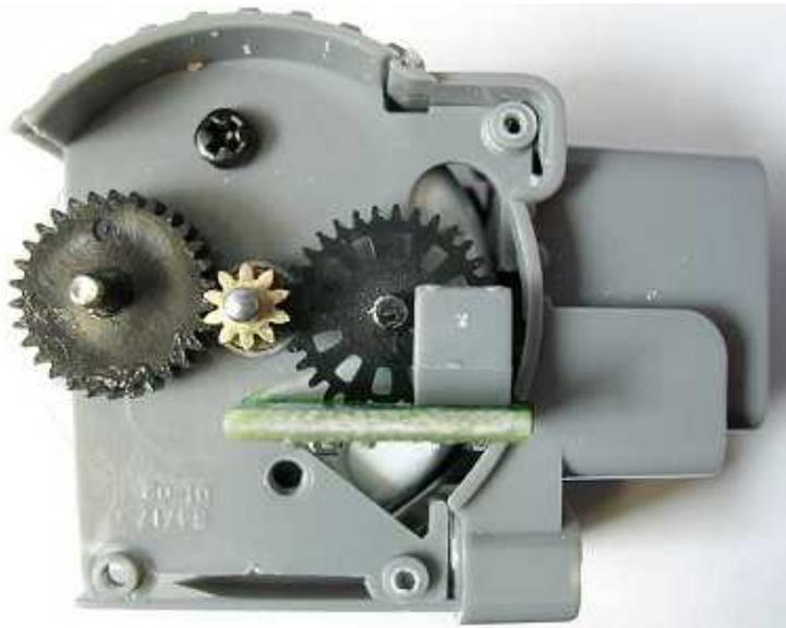
Figura 2.3: Foto dell'encoder montato sull'NXT
