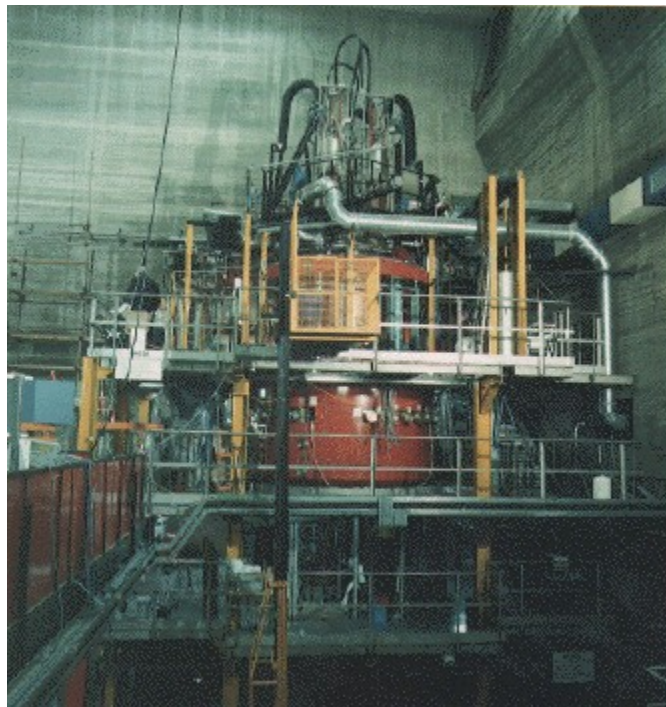
Figura 1.18: Ciclotrone superconduttore (CS) utilizzato nell'accelerazione del fascio primario
