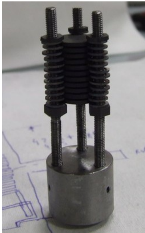
Figura 1.20: Sistema di fissaggio dei dischi di grafite (foto fornita dal team Excyt dei LNS)
