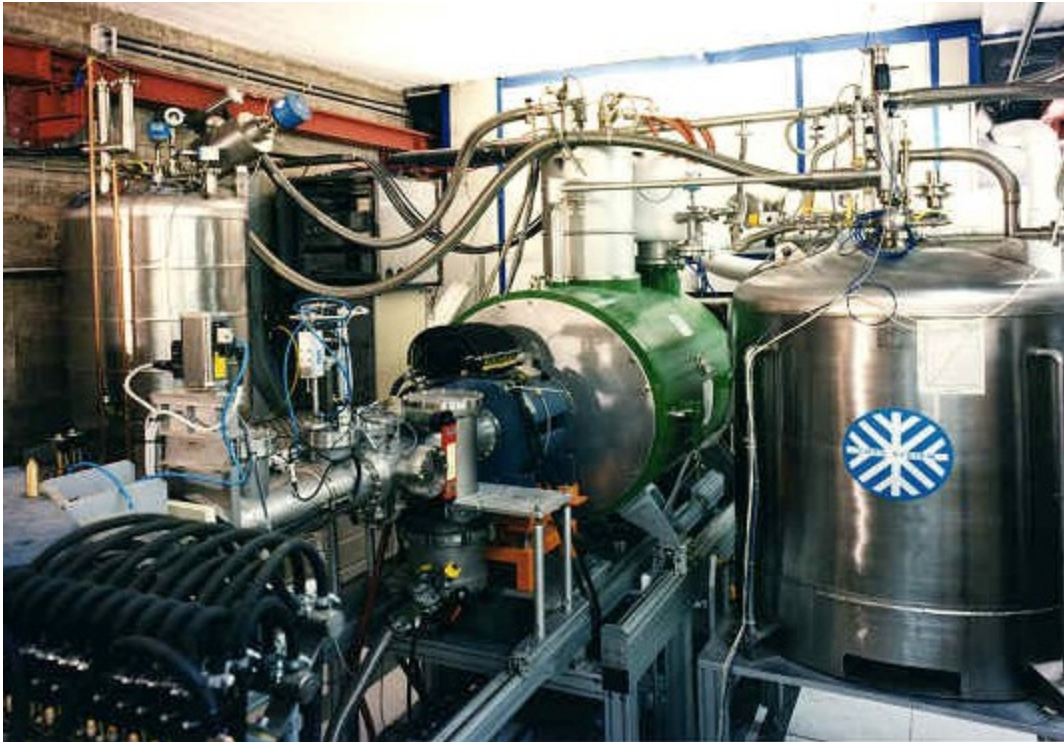
Figura 1.19: Sorgente SERSE ai LNS per la produzione del fascio primario
