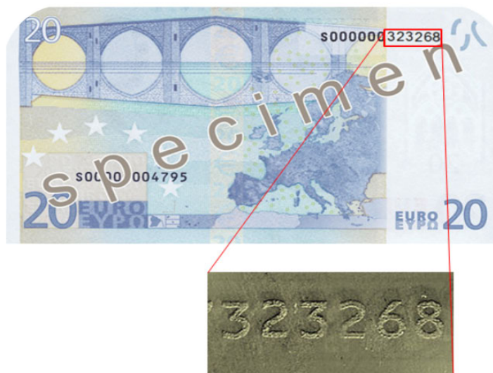
Figura 6: Inchiostri magnetici nella banconota da 20€, immagine magnetica realizzata con sensori a tecnologia magneto-ottica “MagView”[5]
